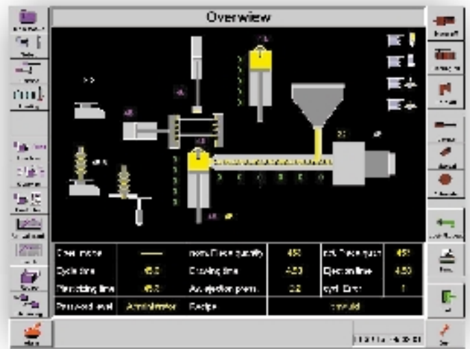
Der Bediener berührt auf dem Maschinenübersichtsbild mit dem Finger ein Maschinenteil und gelangt so auf die entsprechende Bedienseite
