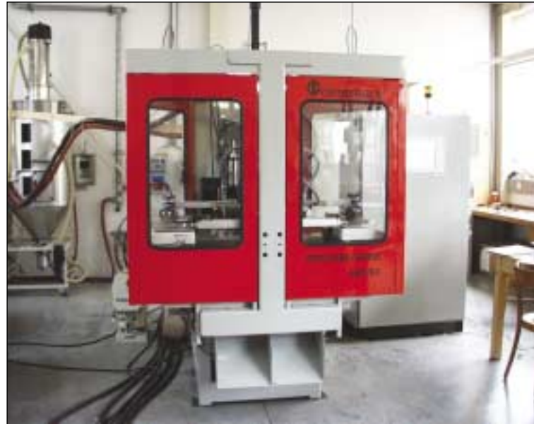
Doppel-Spritzblasmaschine SB2/60 von Ossberger: Damit lassen sich zwei komplexe Teile vollautomatisch fertigen
