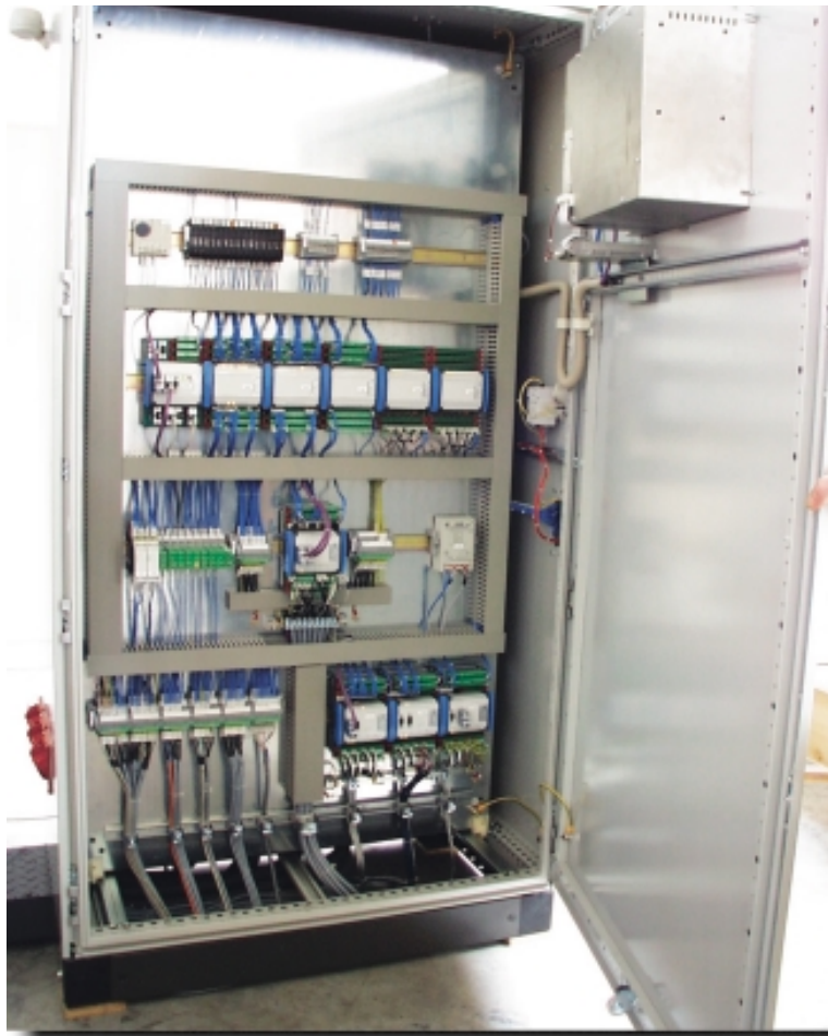
Zentral im Schaltschrank der Spritzblasmaschine angeordnet, befindet sich das DC 150, darüber die SPS-Module und unten die direkt verdrahteten Multi-Temperaturregler; alle Module sind über den CAN-Bus mit dem in der Tür montierten IPC mit 15" Touch-Screen verbunden
