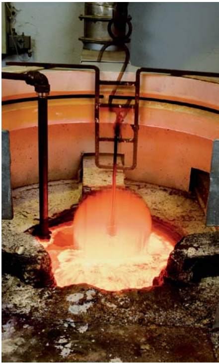
Bild 1: Ein genau vorgegebener Temperaturverlauf und die richtigen physikalischen und chemischen Umgebungsbedingungen können zu einer gezielten Änderung der Werkstoffeigenschaften führen.
