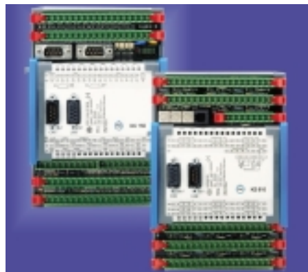
1: Die Module lassen sich zu einem dezentralen Datenlogger mit Fernabfragefunktion kombinieren
